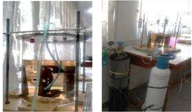
Gambar 3. Chamber uji korosi (tabung berwarna putih berisi gas H_2S dan tabung berwarna hitam berisi CO_2 ) pada suhu ruang
