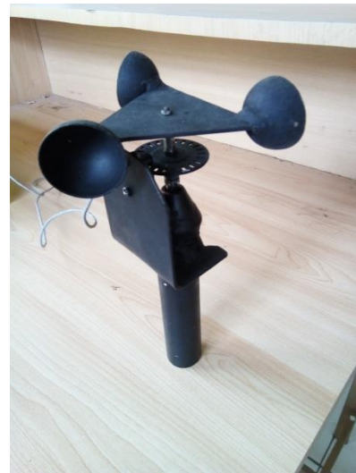
Gambar 5. Realisasi pendeteksi kecepatan angin
