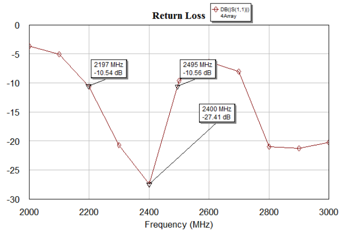
Gambar 4. Return loss antenna dengan susunan peradiasi array 2x2.
