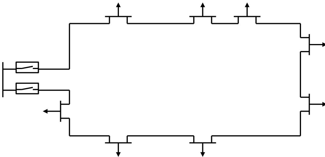
Gambar 4. Struktur Gelang Tertutup (close loop)
