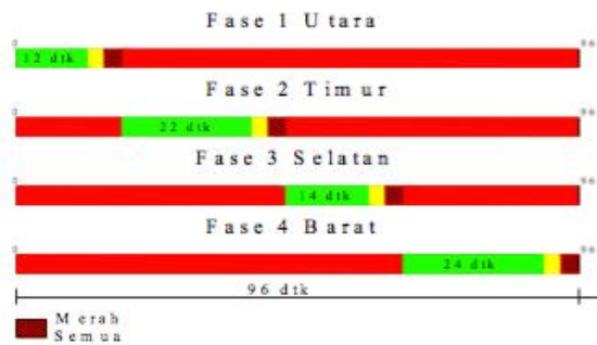
Gambar 8. Diagram Waktu Sinyal Pada Persimpangan Jalan Tingang-Rajawali Kondisi Sekarang
