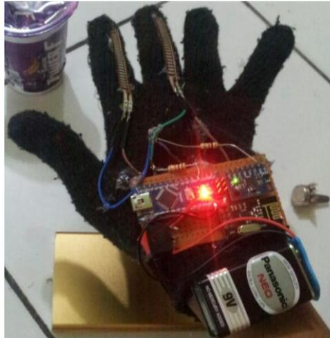
Gambar 8. Sarung Pengendali Lengan Robot
