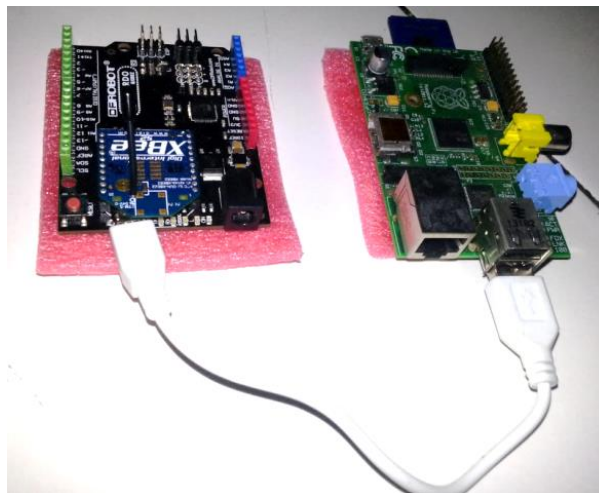
Gambar 3 Pemasangan arduino pada raspberry
