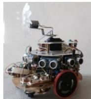
Gambar 3.3 Hasil Perancangan Robot Pemadam Api
