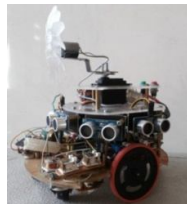
Gambar 3.3 Hasil Perancangan Robot Pemadam Api
