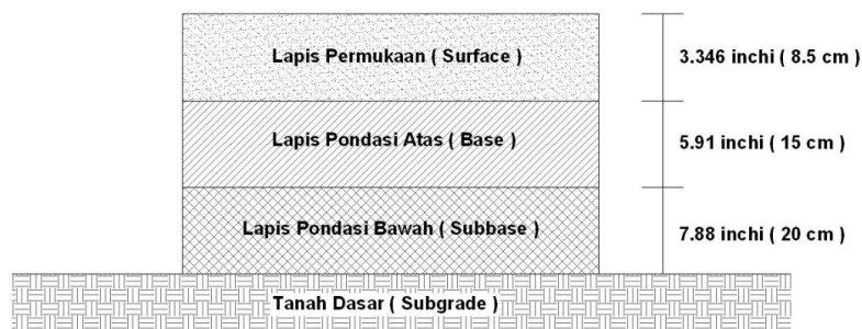
Gambar 2 Ketebalan tiap lapisan perkerasan
