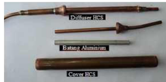
Gambar 2.3 Bentuk dan bagian – bagian Pipa Katalis HCS
