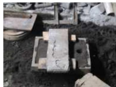
Gambar 2. Cetakan Pasir untuk pengecoran Aluminium-Magnesium (Al-Mg)
