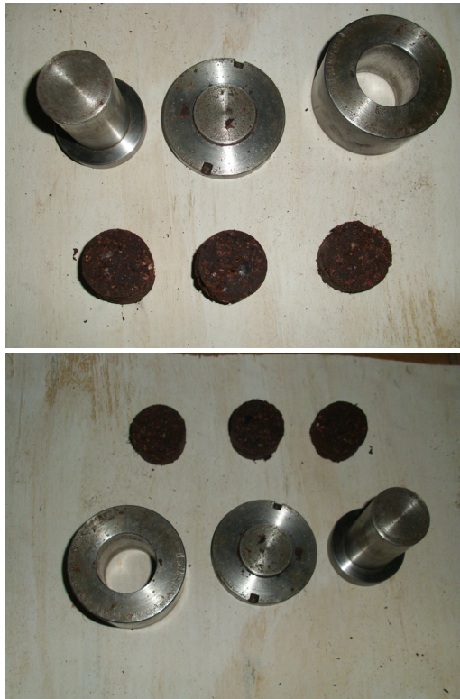
Gambar 4. Hasil cetakan briket yang berbentuk silinder dengan tebal 1,5 cm dan diameter 5 cm
