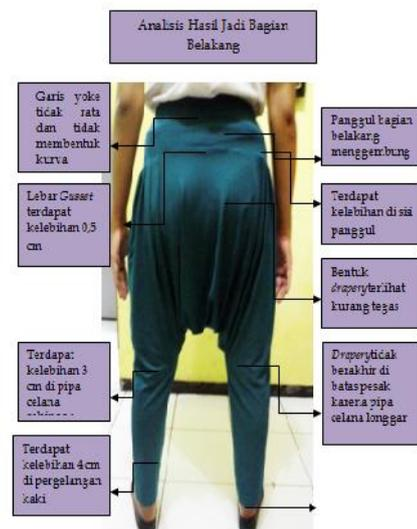
Gambar 15. Hasil Analisis Perbaikan Pada Fitting I Bagian Belakang
