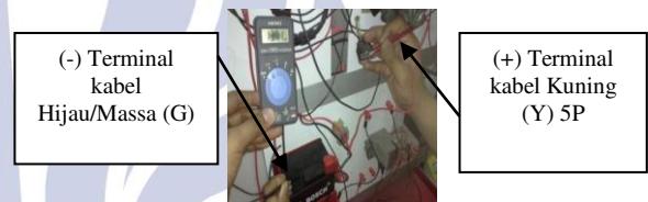
Gambar 26. Mengukur Tegangan Input Throttle Position Sensor pada Terminal Kabel Warna Kuning Konektor 5P Sensor Unit – Massa (Didapatkan Tegangan Sebesar 137,1 mV).
