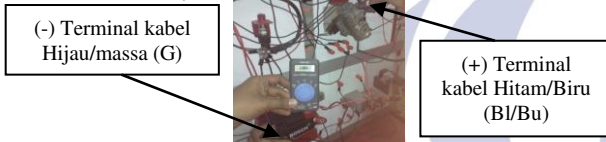
Gambar 34. Mengukur Tegangan Injector (Pada Terminal Kabel Warna Hitam/Biru dan Massa: 11,43 V).
