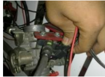
Gambar 33. Memasang Konektor 2P Injector .
