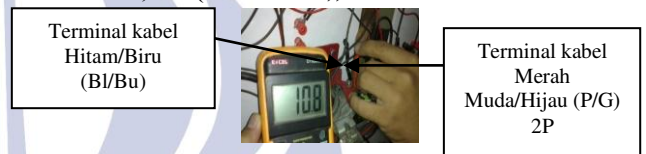
Gambar 36. Mengukur Tahanan Injector Pada Kabel Hitam/Biru dengan Merah Muda/Hijau ( Tahanan: 10,8 Ω ).
