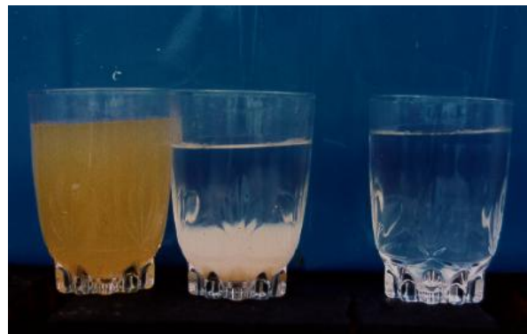
Gambar 10 : Air baku, air olahan yang belum disaring, dan air olahan setelah disaring.
