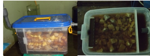
Gambar 6 : Bioreaktor Denitrifikasi Bench Scale .
