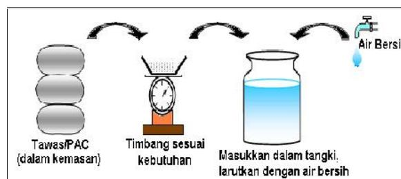
Gambar 4. Cara Pembuatan Larutan Koagulan (Tawas/Alum atau PAC)
