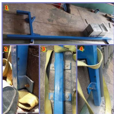
Gambar 7 : Bangunan Tiang Penopang.
