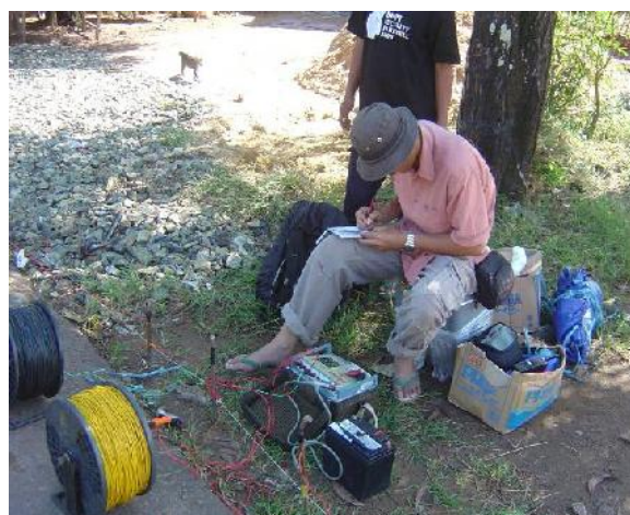
Gambar 7. Pengukuran dan pencatatan nilai-nilai tahanan jenis di lapangan
