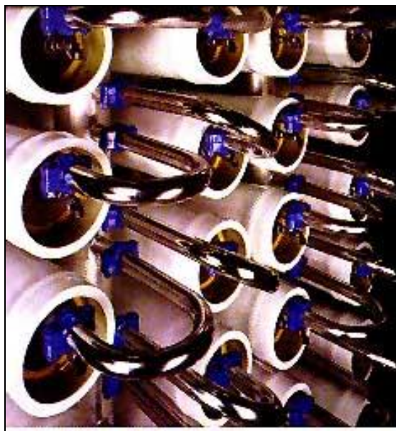
Gambar 4 : Susunan beberapa modul membrane dengan kombinasi seri paralel.
