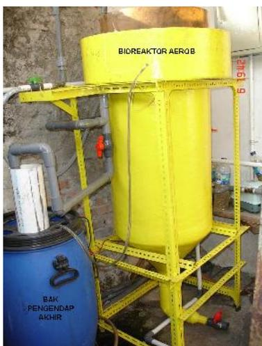
Gambar 4 : Foto bioreaktor yang digunakan selama penelitian.
