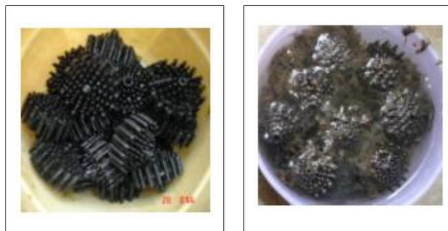
Gambar 6 : Media *bioball* yang masih baru dan media *bioball* setelah digunakan selama 2 minggu.
