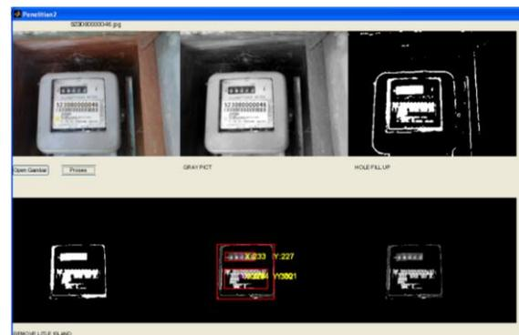
Gambar 6. Pengujian dengan 3 nilai centroid
