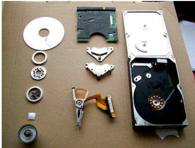
Gambar 10. Bagian secara keseluruhan apabila sebuah harddisk diurai satu per satu
