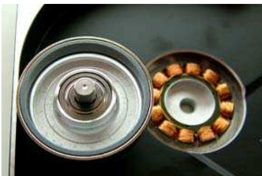
Gambar 6. Bagian spindle ketika dibuka tutupnya
