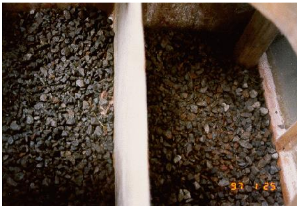
Gambar 3 : media kerikil atau batu pecah untuk media biofilter.
