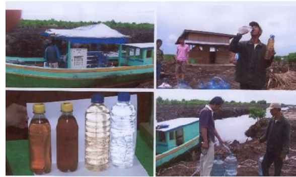
Gambar 19. Unit Pengolah Air Gambut Sistem Reverse Osmosis (Sumber : www.kalimaya.com ).
