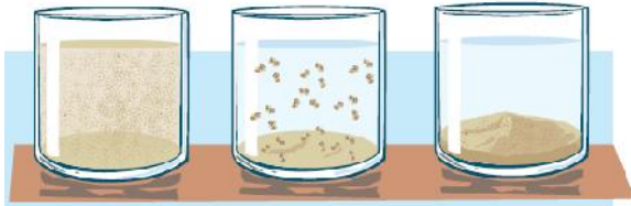
Gambar 4. Proses pengendapan air keruh dengan mempergunakan PAC atau Aluminium Sulfat.
