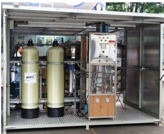
Gambar 17. Unit Pengolah Air Sistem Reverse Osmosis Stasioner Untuk Mengolah Air Asin Kapasitas 10 m 3 /hari.
