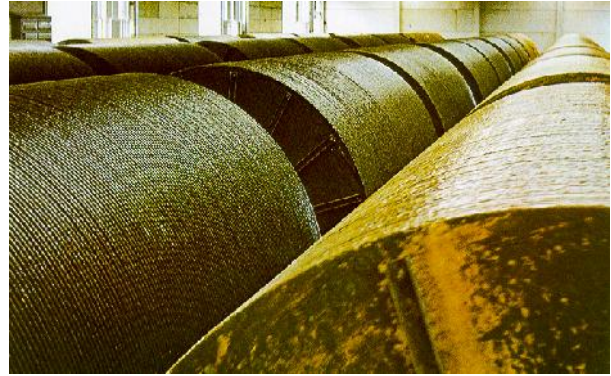
Gambar 9 : Modul media RBC tipe plat datar yang telah dioperasikan. Produksi PASCO Co.Ltd.
