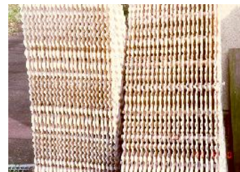
Gambar 4 : Modul media RBC tipe plat bergelombang yang belum terpasang.
