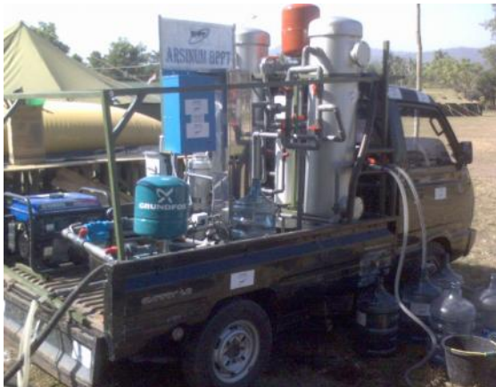
Gambar 1: Unit Pengolahan Air Siap Minum Bergerak
