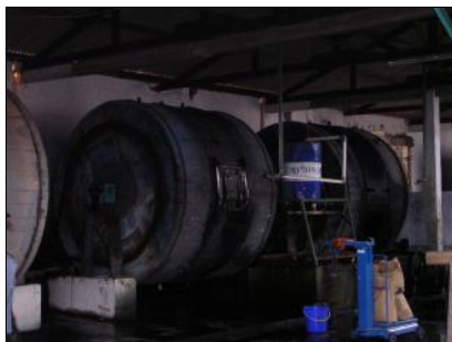
Foto 1 : Tanin ( Rotary Drum ) Reaktor Penyamakan Kulit (sumber limbah B3)
