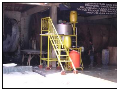
Foto 2 : Peralatan Recovery Crom dari limbah industri penyamakan kulit
