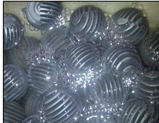
Gambar 7 : Lapisan Biofilm Yang Mulai Terlihat Pada Bioball Di Hari Ke-6 Proses Seeding .
