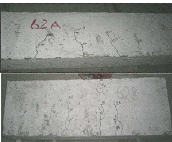
Gambar 9. Pola retak yang terjadi pada variasi tulangan tarik 6 D 7,8 mm
