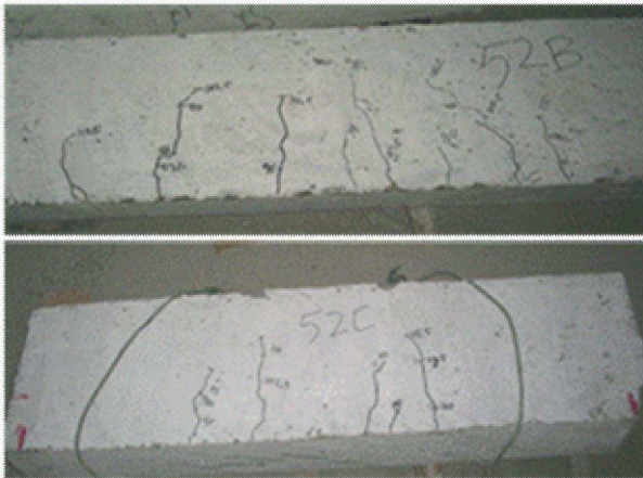
Gambar 8. Pola retak yang terjadi pada variasi tulangan tarik 5 D 7,8 mm
