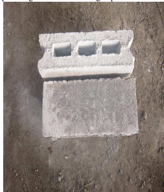
Gambar 4. Contoh batako yang digunakan pada pesisir pantai Teluk Palu
