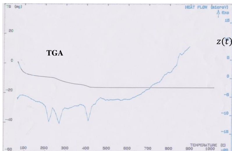
Gambar 1. Grafik DTA-TGA dari prekursor LiFePO 4 /C
