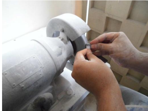
Gambar 8. Proses Penghalusan Dengan Gerinda (Sumber: Alrashid, 2014)
