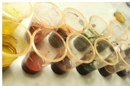
Gambar 3.2 Hasil Pencampuran Zat Warna Dispersi dengan 3 Kelarutan berbeda (sumber :Hirarosa, 2012)
