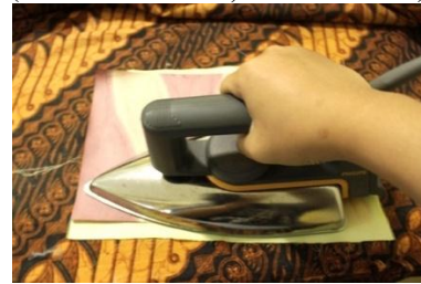
Gambar 4.4 Proses Heat Transferring Menggunakan Setrika (sumber : Hirarosa, 2012)
