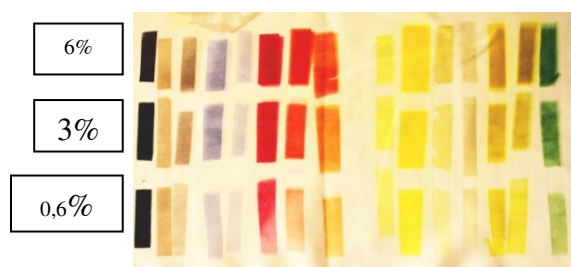
Gambar 3.4 Hasil transfer Zat Warna Dispersi dengan 3 Kelarutan berbeda (sumber :Hirarosa, 2012)
