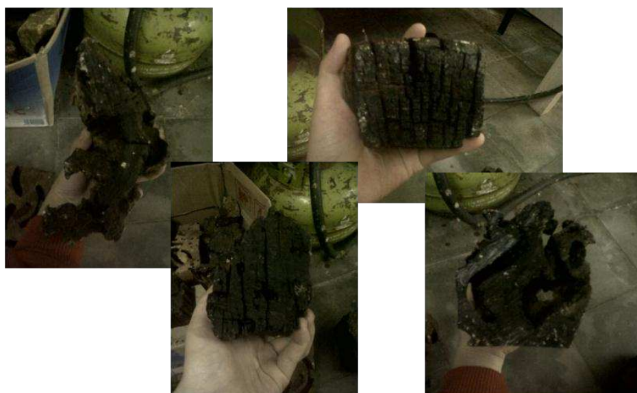
Gambar 2. Balok-balok kayu yang digunakan sebagai alternatif cap untuk batik
