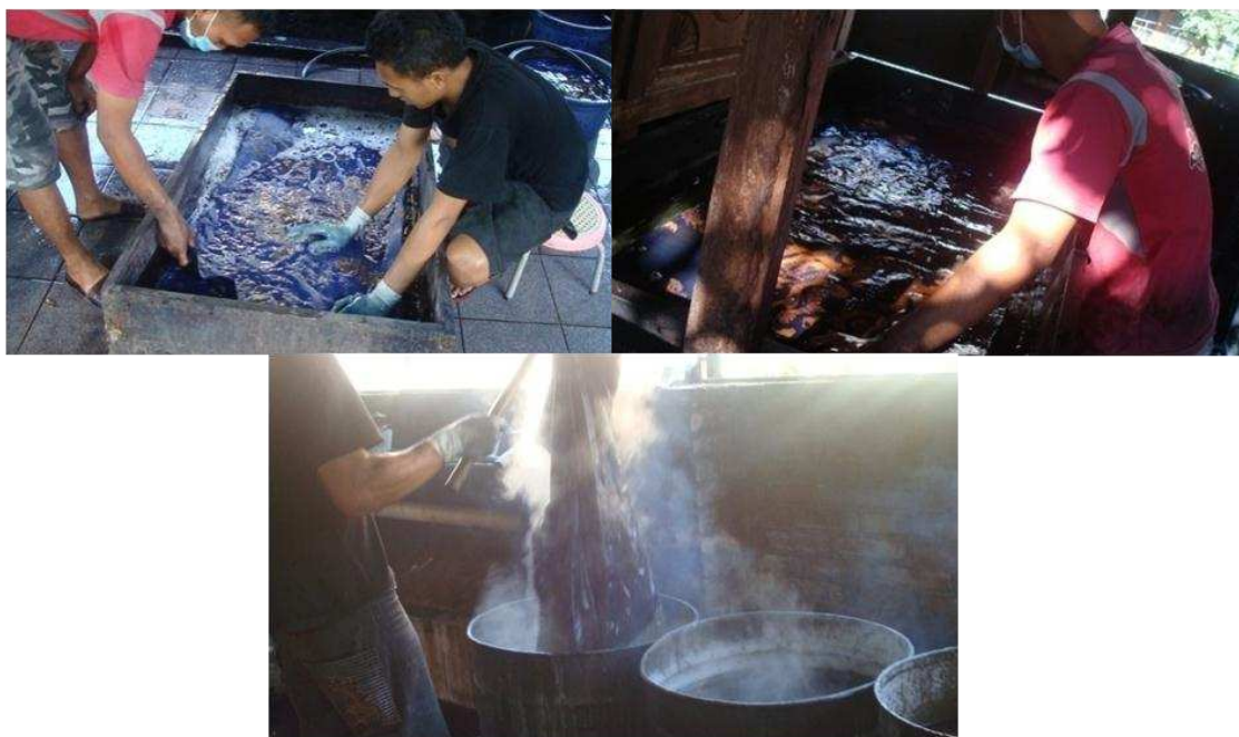
Gambar 3. Proses pencelupan kain ke zat pewarna dan nglorot di Batik Komar (dok. Fitria, 2013).
