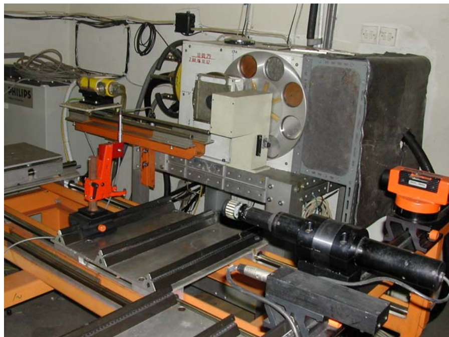
Gambar 1. Sumber radiasi untuk keperluan kalibrasi alat ukur radiasi menggunakan berkas sinar-X yang memerlukan biaya perawatan cukup besar.
