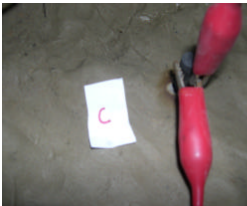
Gambar 9b. Warna seperti karatan yang timbul di titik C
