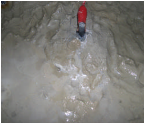
Gambar 8. Gelembung air dan warna putih susu yang keluar dari katoda
