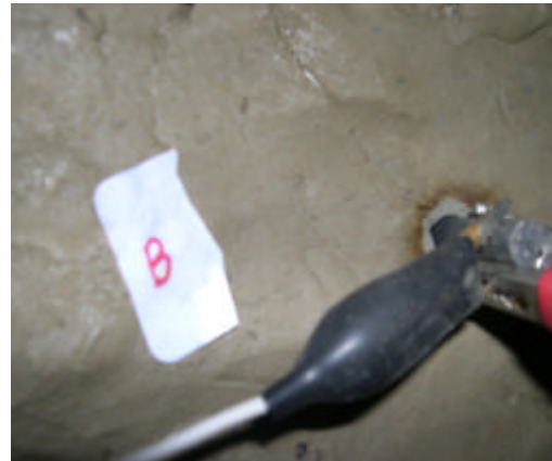
Gambar 9a. Warna seperti karatan yang timbul di titik B
