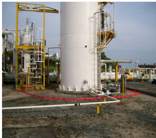
Gambar 1. Patok dan penandaan area dengan laju dosis lebih dari 50 \mu\text{R}/\text{jam}
