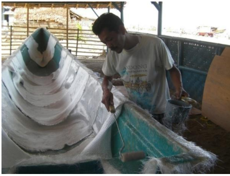
Gambar 5 Pelapisan mat dan roving
