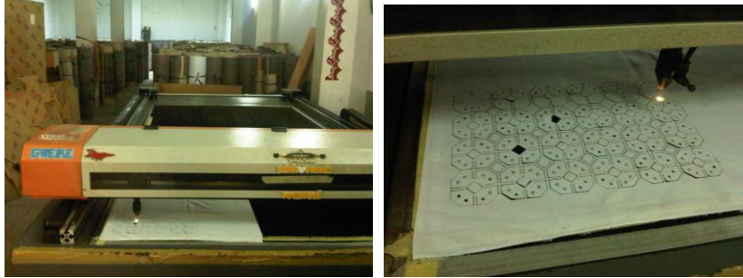
Gambar 12. Proses pemotongan oleh mesin wide laser cutting.
