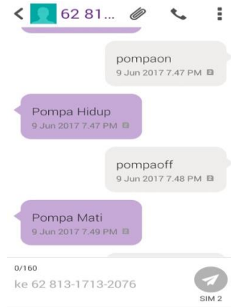
Gambar 10. Perintah untuk mengaktifkan dan mematikan pompa air.
