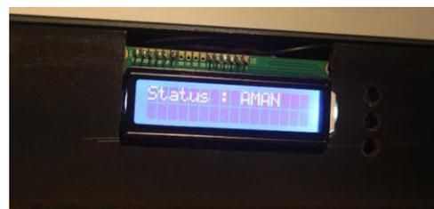
Gambar 6. Tampilan Prototipe detektor kebakaran gas LPG
