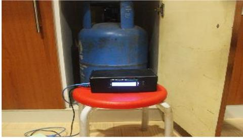
Gambar 7. Tampilan uji letak detektor dengan tabung gas
