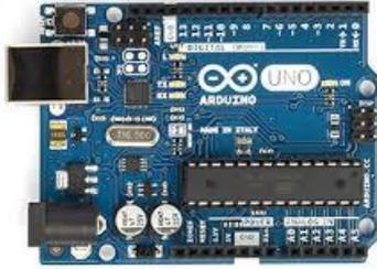
Gambar 3. Mikrokontroler Arduino UNO R3
