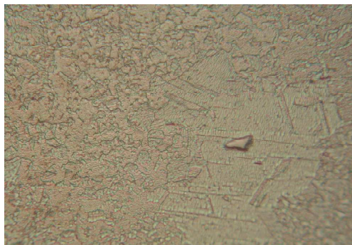
Gambar 11(h). Strukturmikro kawat tembaga Ø 0,25 mm tanpa annealing awal (TA1) dan annealing akhir (A2.2) T 440°C
