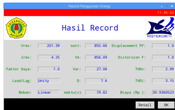
Gambar 13. Hasil rekap rekaman untuk beban heater
