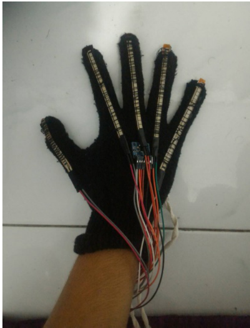
Gambar 2. Sarung tangan dengan sensor flex dan MPU-6050 dengan posisi jari lurus
