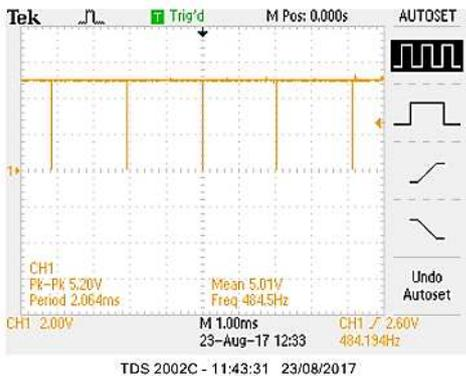
Gambar 11. Hasil Pengukuran Sinyal Keluaran PWM pada Lampu LED kondisi on pertama kali
