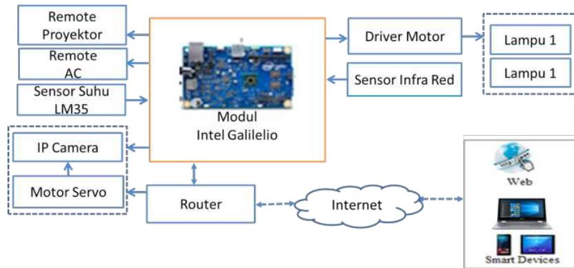
Gambar 3. Skema sistem pintar pengendali multi perangkat
