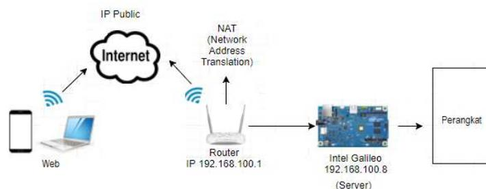
Gambar 4. Skema jaringan sistem pengendali
