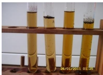
Gambar 4. Asap cair yang dihasilkan oleh kondensor pirolisis pada interval waktu 30,60,90 dan 120 menit. A) sebelum pengendapan dan B) setelah pengendapan semalam.
