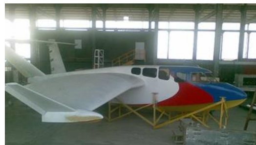
Gambar 4. Mock up pesawat WISE L8 efek permukaan konfigurasi Lippisch kapasitas 8 orang
