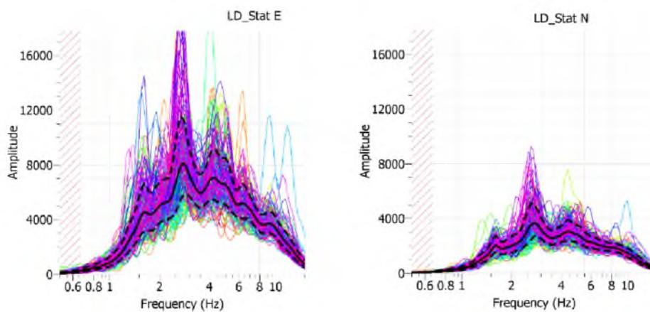
Gambar 1. Hasil FFT Mikrotremor pada Tanah (Ground)
