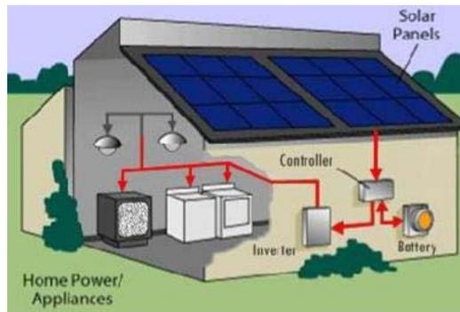
**Gambar 4. Solar Home Sistem dan komponen-komponennya. [7]**
