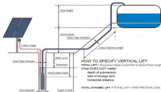
**Gambar 5. Aplikasi photovoltaic pada pompa air tenaga surya.[9]**
